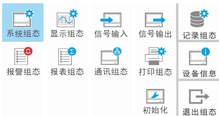
(2) 进入系统组态，按左移键和右移键移动光标至系统时间按确认键，或直接点击系统时间输入框，打开输入时间对话框。
