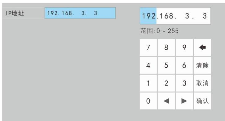
**按键:** 移动光标至要修改的值，按确认键，右边弹出多段数字键盘。方向键移动光标，确认键执行。
