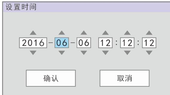
**按键:** 移动光标至要修改的值，按确认键，右边弹出数字键盘。左右键移动光标，上下键修改值，确认键执行。
