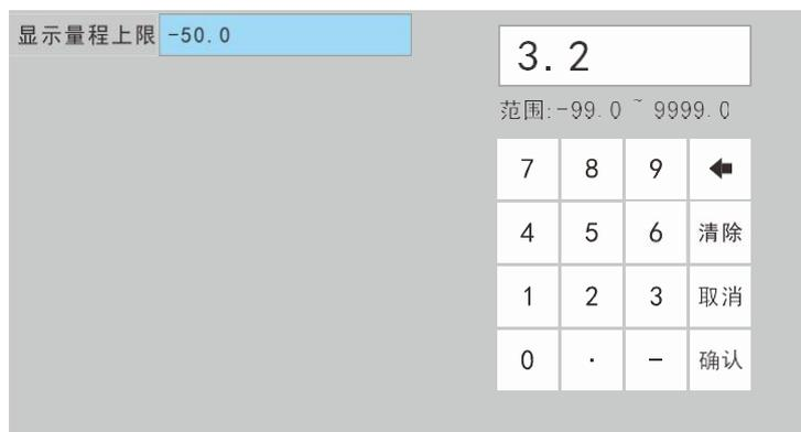
**按键:** 移动光标至要修改的值，按确认键，右边弹出数字键盘。方向键移动光标，确认键执行。
