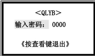
用增加键修改闪烁位值，用右移键选择修改位。输入完 4 位正确密码，按进入键即进入下面编程参数设置显示界面。
