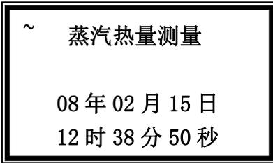
信息栏显示仪表在累计方式 如瞬时流量大于流量量程，显示：超量程运行，如瞬时流量小于下限流量，显示：下限流量运行，如瞬时流量小于设置的微小流量值，并温度 A，数值大于设置的检测温度，延时时间过后，显示：微小流量运行
