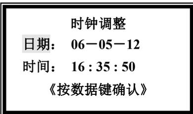
日期设置和时间设置,字体反白显示的为当前可修选项。用增加键修改闪烁位值，用右移键选择修改位。先设置日期，设置完后，按数据键确认，再按
