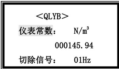
当工作方式为 1~15 时，流量信号为脉冲，需设置涡街传感器仪表常数，小信号切除频率值。切除频率值范围：00~99Hz。
