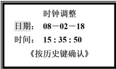
日期和时间设置，字体反白显示的为当前可修改项。右移键选择修改位，用增加键修改闪烁位值，先设置日期，设置完后，按历史键确认，再按进入键设置时间，同样按历
