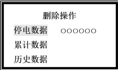
删除操作共三项。操作示例：如要删除停电数据记录，按右移键使 6 个“○”符号依次消失，停电数据记录即被删除。按进入键，进入下一删除项，进行同样操作，累计数据即被删除。如不需删除数据，就连续按进入键，进入保存设置参数 显示界面。
