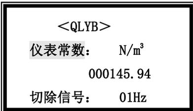
设置涡街传感器仪表常数，小信号切除频率值。切除频率值范围：00~99Hz。
