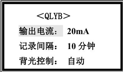
选择输出模拟电流形式,按增加键输出电流在 10 和 20mA 间变换。按进入键确认。选择记录间隔时间,按增加键记录间隔在 01、05、10、20、30、60 间变换,按进入键确认。按增加键选择液晶屏背光控制:自动或常亮。
