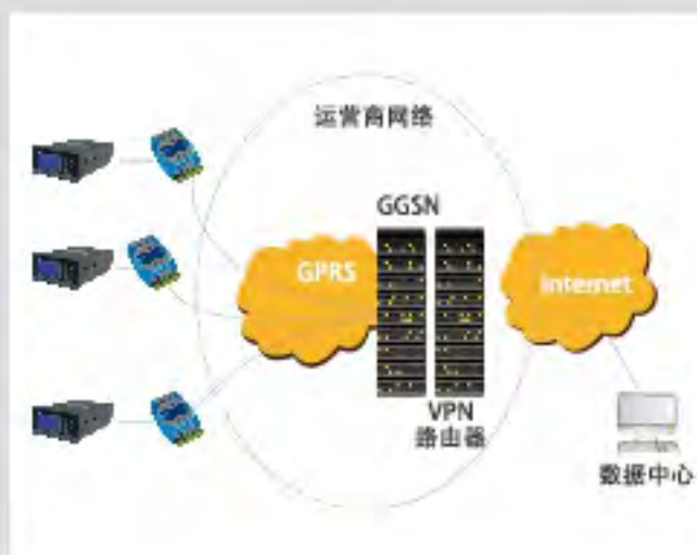
GPRS无线通讯方式 热网管理监控系统
