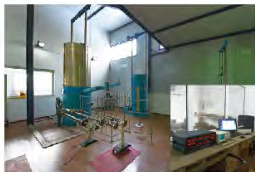
钟罩式气体流量标准装置
